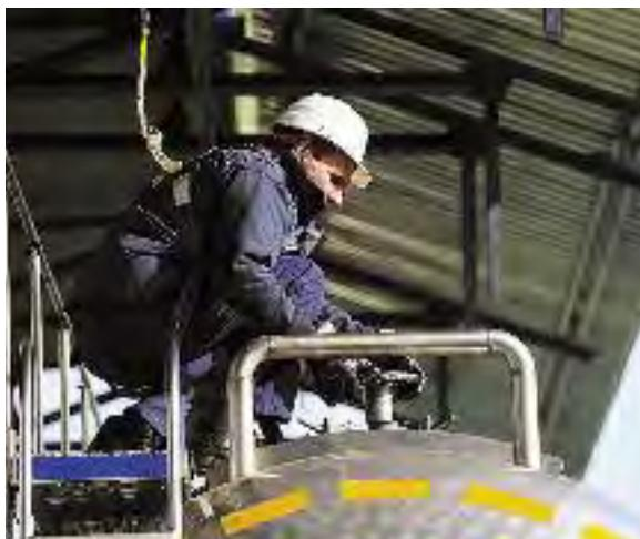
*Operazioni di carico di lubrificante usato in una autobotte*
